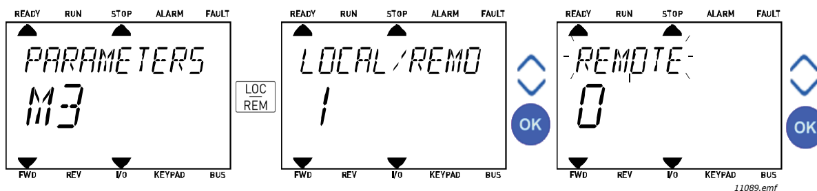
Рис. 10. Переключение между источниками управления
